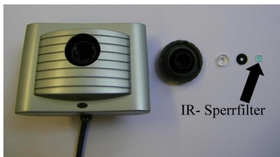
Abb.1: WebCam: Lifetec LT 9388 PC Camera mit IR-Sperrfilter
