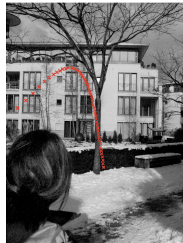
Abb.6: Aufnahme eines schiefen Wurfs aus der Perspektive des Werfers mithilfe einer Hochgeschwindigkeitskamera.
