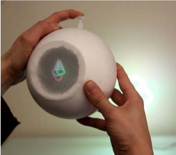
Abb. 20: Durch Druck auf die Spritze wölbt sich die Augenlinse stärker, das Bild erscheint scharf.
