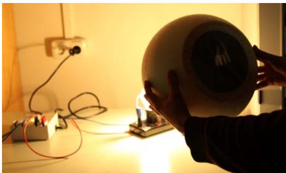
Abb. 18: Mit Hilfe des Lochkameramodells wird das Bild der Kohlefadenlampe auf dem transparenten Schirm an der Hinterseite des Modells dargestellt.
