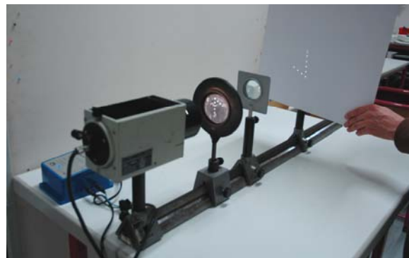
Abb. 15: Experiment zur Untersuchung der Größen von Gegenstand und Bild sowie Gegenstandsweite und Bildweite
