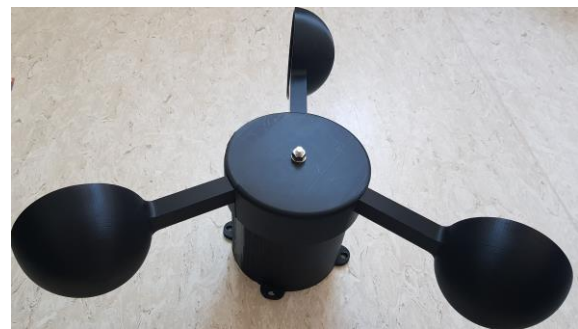
Abb.4: Zusammengesetztes Anemometer - 3D gedruckt. Eigene Darstellung.
