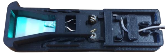
Abb. 3: Unterseite der Abdunklungsbox mit eingespanntem LED-Einsatz. Eigene Darstellung.
