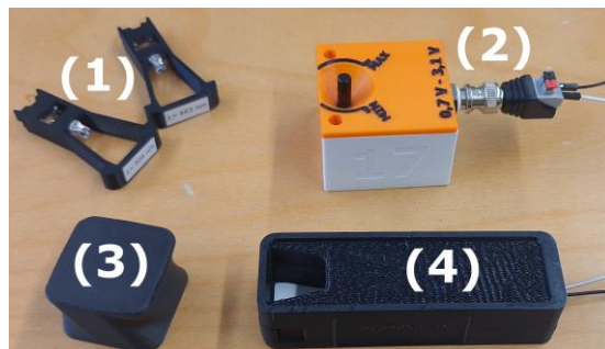
b) Die zu fertigenden Module des Aufbaus. (1) LED-Einsätze. (2) phyphox:h-Box zur Spannungsausgabe. (3) Stabilisierungshilfe. (4) Abdunklungsbox mit weißem Reflexionsmaterial. Eigene Darstellung.
