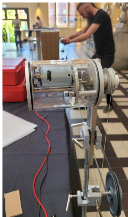
Abb. 1: Dynamot-Aufbau als Analogmodell zu Entwicklung der Energieversorgung in der Garn-Fabrik Nordwolle; Bildquelle: M. Komorek
