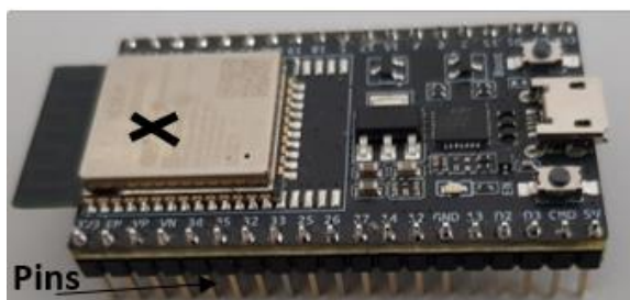
Abb. 1: ESP32-Wroom-32D mit integriertem Hall-Sensor (schwarzes Kreuz) unter der Metallbeschichtung und den integrierten Touch-Sensoren, die sich unter folgenden Pinbelegungen befinden: 0, 2, 4, 13, 12, 14, 27, 32, 33. (Pins als kleine, graue Metallkontakte sichtbar, die auf der Seite oder Unterseite des Mikrocontrollers angeordnet sind). Keine externen Sensoren angeschlossen. Eigene Darstellung.
