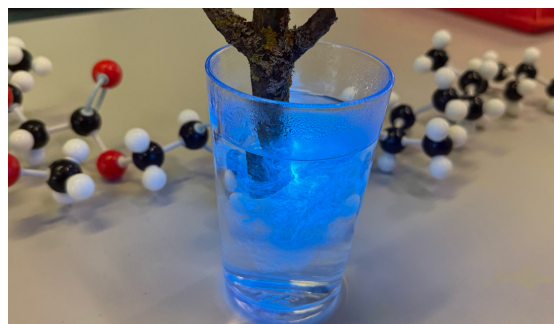
Abb. 4: Zu sehen ist ein Fluoreszenzexperiment mit dem Molekül Aesculin aus einem Kastanienast. Angeregt wird der in warmen Wasser gelöste Stoff mit einer UV-Lampe bei 365 nm Wellenlänge. (Eigene Darstellung)
