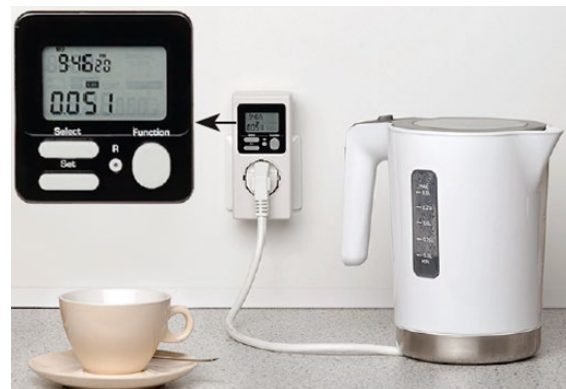
Abb. 9: Versuch zur Messung von Leistung und Energie eines Elektrogerätes aus Physik-Schulbuch [8]
