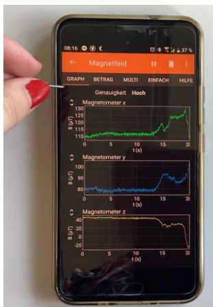
Abb. 2: Lokalisierung des Magnetfeldsensors im Smartphone.
