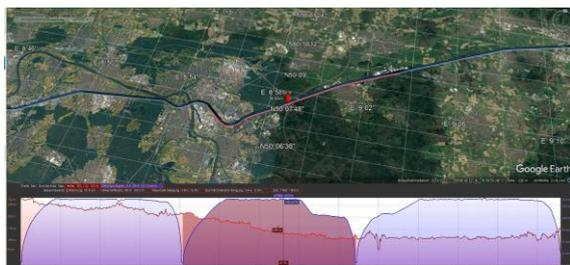
**Abb. 1:** Karte mit Bahnkurve einer Zugfahrt von Gelnhausen nach Offenbach in „Google Earth“ mit einem Zeitdiagramm von Höhe und Geschwindigkeitsbetrag (Kartendaten ©2024 GeoBasis-DE/BKG (©2009) dl-de/by-2-0 (Daten verändert) (2024) Bilder ©2024 TerraMetrics)
