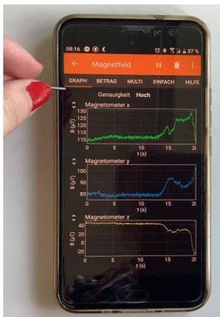
Abb. 2: Lokalisierung des Magnetfeldsensors im Smartphone.
