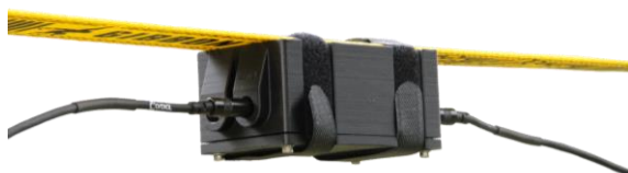
Abb. 8: An einer Slackline mit Klettbändern befestigte Sensorbox.
