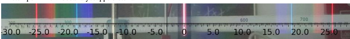
Abb. 7: Das Beugungsbild an einem Gitter wurde mit einer Skalen-Achse versehen. Die Abstände der Maxima vom nullten Maximum können nun abgelesen und für Berechnungen verwendet werden.
