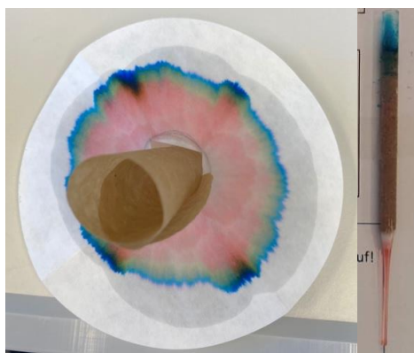
Abb. 12: Ergebnisse aus der Chromatographie mit schwarzer Filzstiftfarbe: Filterpapier-Methode (links) und Säulenchromatographie-Methode (rechts)
