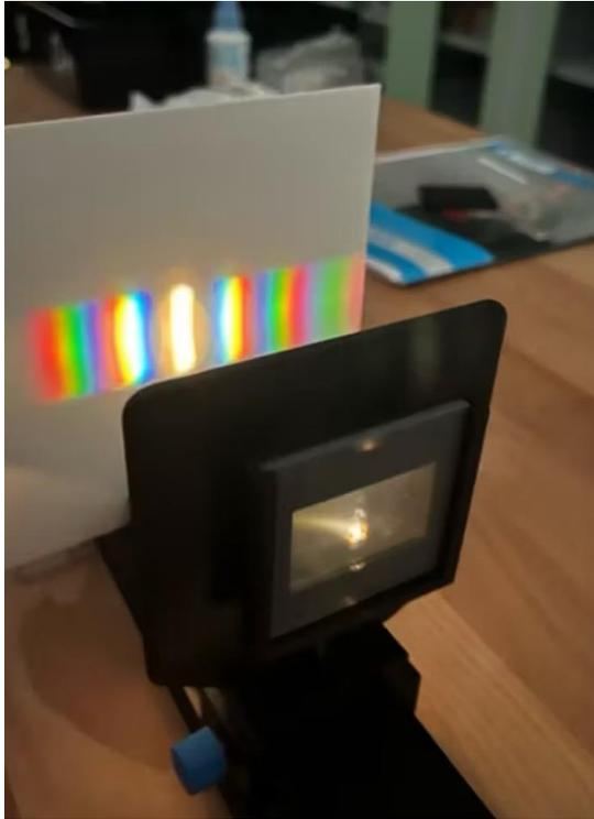
Abb. 6: Beugung von Licht an einem Gitter
