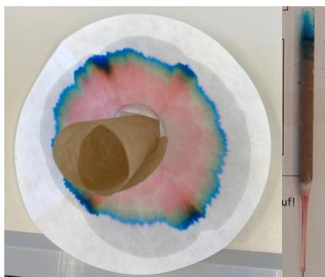
Abb. 12: Ergebnisse aus der Chromatografie mit schwarzer Filzstiftfarbe: Filterpapier-Methode (links) und Säulenchromatografie-Methode (rechts)
