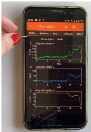
Abb. 2: Lokalisierung des Magnetfeldsensors im Smartphone.
