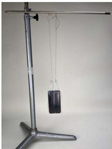
Abb. 4: Ein Fadenpendel mit einem Smartphone als schwingende Masse.
