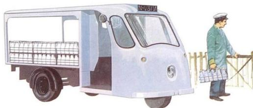
Hier ist ein elektrischer Milchwagen. Dieser Wagen ist langsamer als normale Autos. Aber er verschmutzt die Luft nicht. Er wird über Nacht mit Elektrizität aufgeladen. Man versucht, die elektrischen Autos zu verbessern. Eines Tages werden wir nur in Elektroautos fahren.
