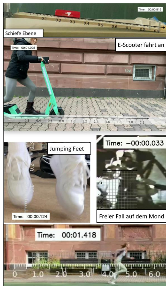
Abb. 5: Beispiele für Videos von, bei denen mit der Goethe-Video-Suite nachträglich ein Zeitstempel (und eine Skalen-Achse) eingefügt wurde (Quelle des Mond-Videos: [1]).
