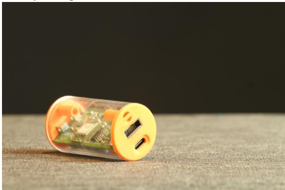
Abb. 4: Die phyphox Satelliten-Box verfügt über viele Sensoren, die prinzipiell auch in Smartphones verbaut sind, hier aber für physikalische Experimente optimiert ausgewählt wurden.
