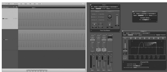
Abb. 13: Experiment zum Kammfiltereffekt mit einem Sequenz.
