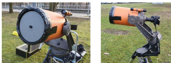
Abb.4: Teleskop mit Doppelspaltaufsatz und Kamera
