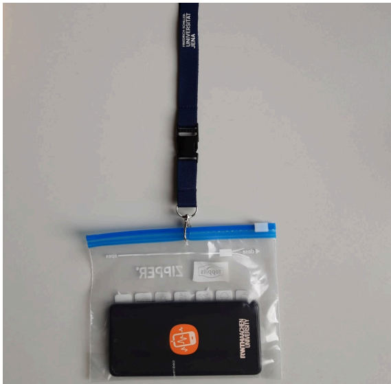
Abb. 2: Versuchsaufbau zum Pendel aus einem Smartphone, einer Plastiktüte mit Zip-Verschluss und einem Schlüsselband.
