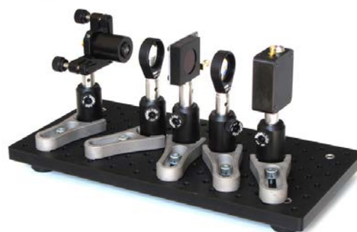
Abb. 2: Einfacher NV-Aufbau der Firma Advanced Quantum für die Lehre. Die Datenaufnahme erfolgt über ein lokales Netzwerk und die Steuerung über einen beliebigen Browser [8].
