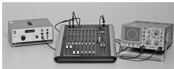
Abb.8: Oszilloskop im x-y-Betrieb zur Darstellung einer Phasenverschiebung zwischen L- und R-Signal. Das Mischpult mit seinen Filterschaltungen dient hier als Phasenschieber.
