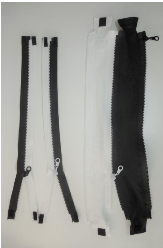
Abb. 5: Zwei einfache und ein doppelter Streifen aus jeweils zwei modellgleichen Reißverschlüssen in weiß und schwarz.
