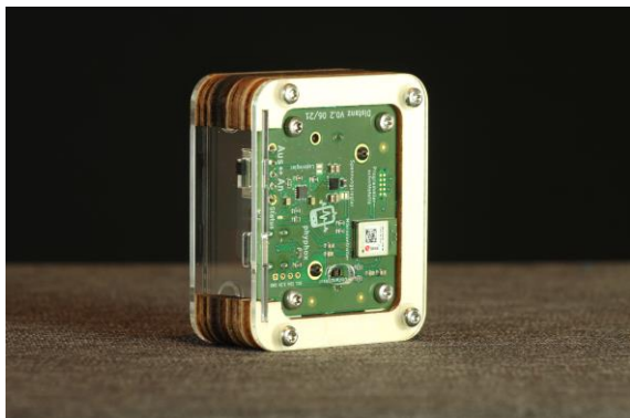
Abb. 2: Die phyphox Distanz-Box mit einem ToF-Sensor misst Distanzen von bis zu vier Metern bei einer Messrate von 50 Hz.
