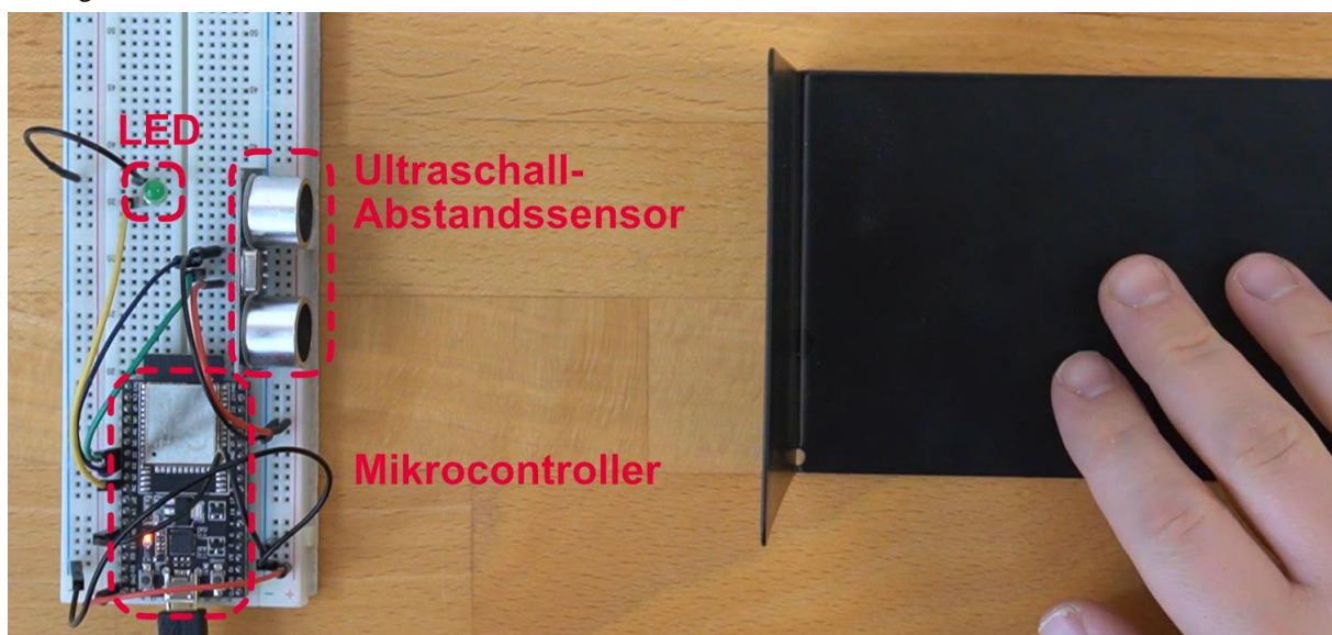
Abb. 1: Minimalbeispiel: Mikrocontroller, LED und Ultraschall-Abstandssensor zur Demonstration der Kommunikation zwischen Mikrocontroller und Endgerät für verschiedene Schnittstellen
