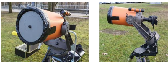
Abb.4: Teleskop mit Doppelspaltaufsatz und Kamera
