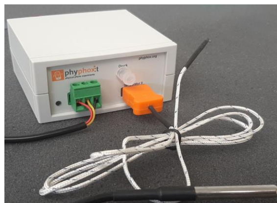
Abb. 3: Mit Hilfe der phyphox Wärmelehre-Box können thermodynamische Größen gemessen werden. Neben einer Druckmessung ist die Messung der Temperatur in verschiedenen Messbereichen möglich.
