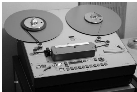
Abb. 15: Magnetbandgerät für Rundfunkzwecke um 1980. Noch heute werden solche Geräte für verschiedene Aufgaben in der Studioteknik eingesetzt.
