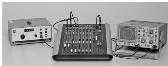
Abb.8: Oszilloskop im x-y-Betrieb zur Darstellung einer Phasenverschiebung zwischen L- und R-Signal. Das Mischpult mit seinen Filterschaltungen dient hier als Phasenschieber.
