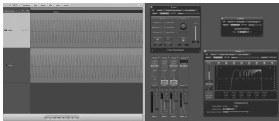
Abb. 13: Experiment zum Kammfiltereffekt mit einem Sequencer.
