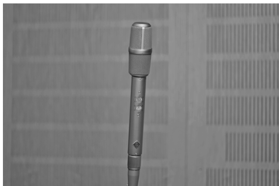
Abb. 7: Mikrofon für die Intensitätsstereofonie. Beide Mikrofonkapseln sind hier direkt übereinander angeordnet.
