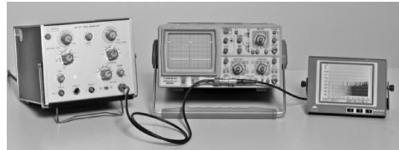
**Abb. 17:** Das mit einem FFT-Spektrometer (rechts) dargestellte Frequenzspektrum eines Pulssignals.
