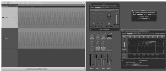
Abb. 13: Experiment zum Kammfiltereffekt mit einem Sequencer.
