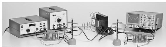
**Abb. 2:** Versuchsaufbau zur Demonstration der symmetrischen Leitungsübertragung.
