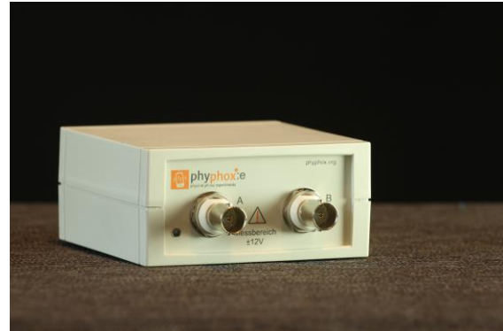
Abb. 1: Die E-Lehre-Box ermöglicht die Messung von Spannungswerten im Messintervall von -12\text{V} bis +12\text{V} und kann je nach gewünschter Zeitaufösung in zwei Mess-Modi betrieben werden.
