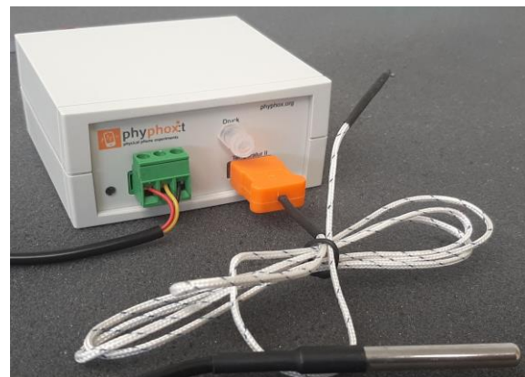
Abb. 3: Mit Hilfe der phyphox Wärmelehre-Box können thermodynamische Größen gemessen werden. Neben einer Druckmessung ist die Messung der Temperatur in verschiedenen Messbereichen möglich.
