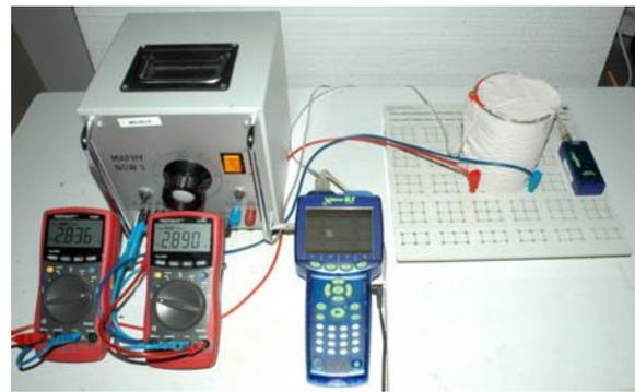
Abb. 3: Die in Papiertücher gewickelte Blechdose mit Glühlampe im Inneren stellt den menschlichen Körper dar.
