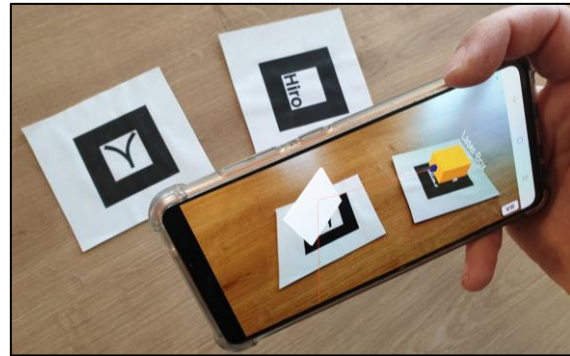
Abb.3: WebAR-Simulation eines Optik-Versuchs im Strahlenmodell
