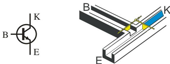
**Abb.6:** Bipolartransistor (npn) und Analogie im Wassermodell (Schleusenmodell nach E. Nehmann).
