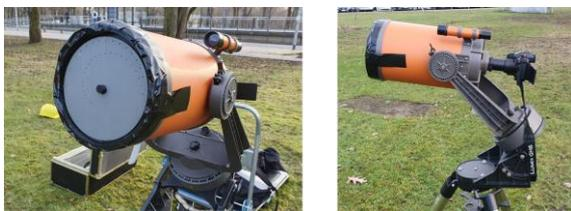
**Abb.4:** Teleskop mit Doppelspaltaufsatz und Kamera
