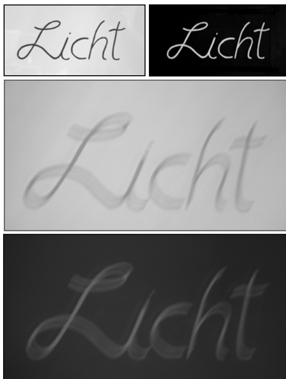
Abb. 12: Komplementäre Schattenbilder inverser Blenden. Der i-Punkt des Schriftzugs liefert ein dunkles (oben) und
