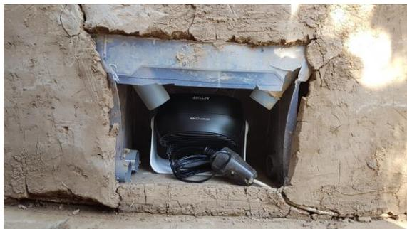
**Abb. 10:** Ein Mini-Heizlüfters in der inneren Plastikkiste steht für die Abwärme der Termiten bzw. der Pilze
