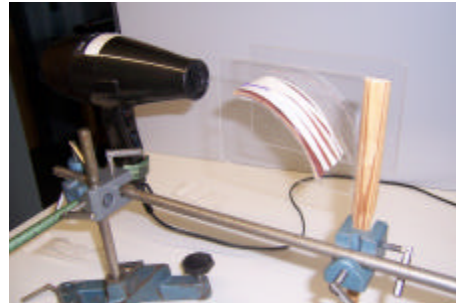
Abb. 6b Versuch zum Coandaeffekt
