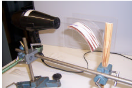
Abb. 6b Versuch zum Coandaeffekt
