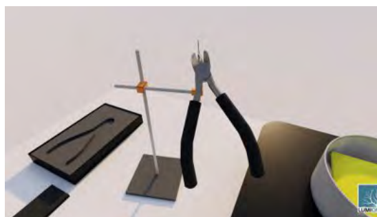
Abb.10: Präparation der Messspitze aus dem Draht mit dem Seitenschneider an der Haltevorrichtung
