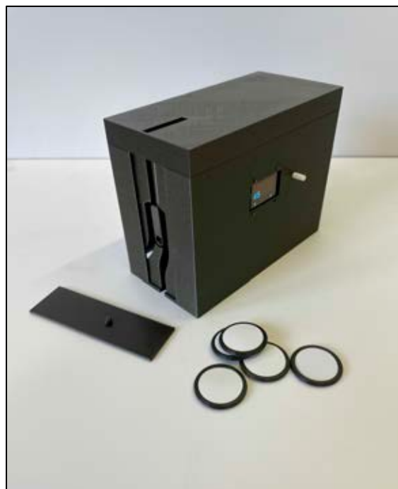
Abb.3: Prototyp des Polarisationsmoduls zum Analogie-Experiment.
