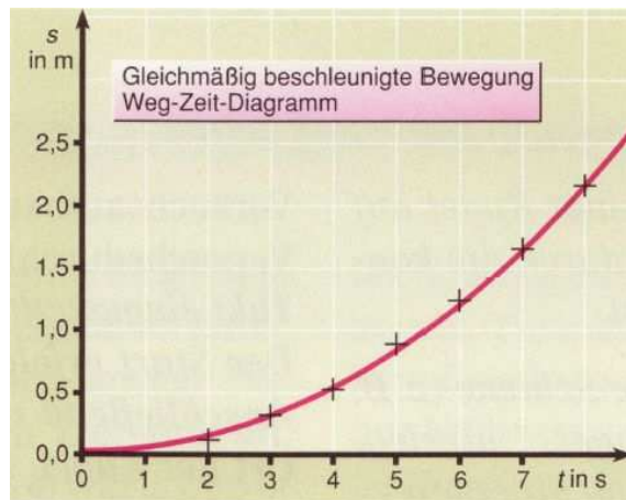
Abbildung 58: s-t-Diagramm einer gleichmäßig beschleunigten Bewegung aus B1-8
