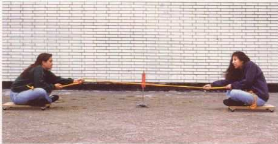
Abbildung 20: Versuchsaufbau zum Wechselwirkungsprinzip aus B1-7
