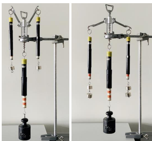
Abb. 7: Präparierter Flügelkorkenzieher als „Lastkran“: Rechts ist die Gleichgewichtssituation hergestellt.
