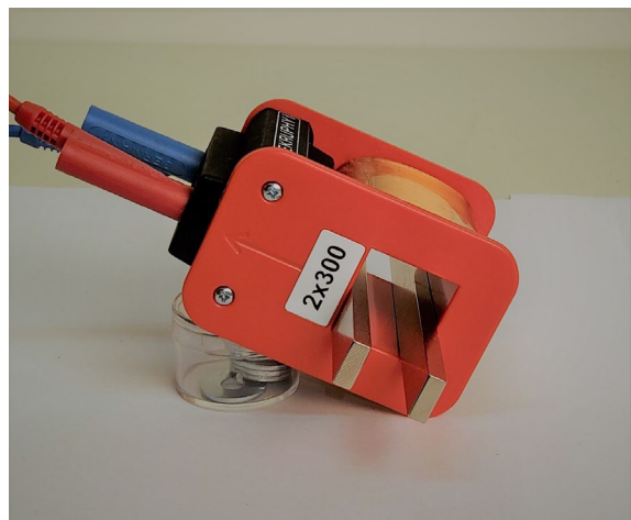
Abb.3: Das stromdurchflossene Weicheiseninstrument
