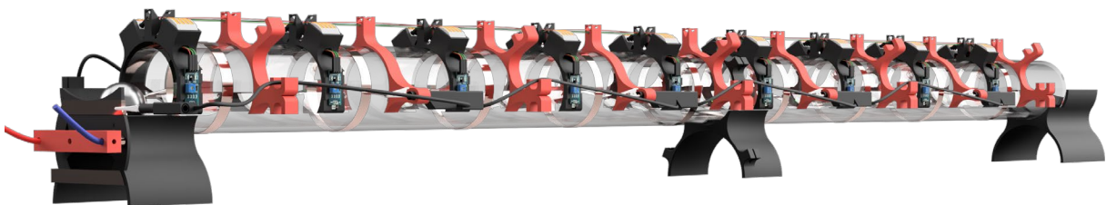
Abb. 3: 3D-gedrucktes, mikrocontroller-gesteuertes Modell eines Wechselspannungs-Linearbeschleunigers
