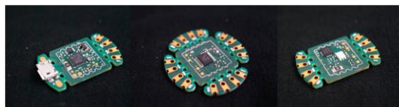
Abb. 4: Hauptplatine, Analog-digital-Wandler und LED-Modul (von links nach rechts) aus einem Toolkit für E-Textiles. Aus Garbacz, K.; Stagun, L.; Rotzler, S.; Semenec, M.; von Krshiwoblozki, M. (2021) Modular e-textile toolkit for prototyping and manufacturing. Proceedings 68, 5. DOI: https://doi.org/10.3390/proceedings2021068005 , im Original veröffentlicht unter einer CC-BY-Lizenz.
