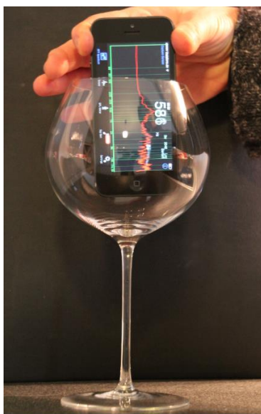
Abb. 25: Ein Rotweinglas als Helmholtz-Resonator
