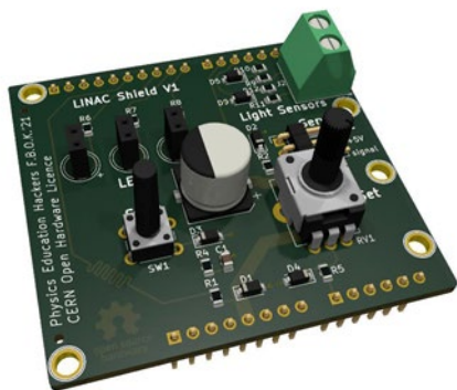
Abb. 4: LINAC-Shield zum Aufstecken auf einen Arduino Uno
