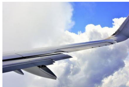
Abb. 9: Mit Auftriebshilfen (Start- und Landeklappen) kann der Auftriebsbeiwert vergrößert werden [14].
