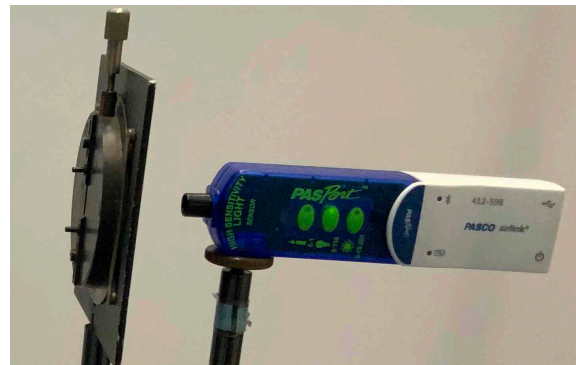
Abb.10: Sensoren der PASPORT-Serie von PASCO können drahtlos mit dem AirLink Interface zusammen mit anderen Wireless-Sensoren genutzt werden, hier mit einem Licht-Sensor hoher Sensitivität zur Bestimmung der Lichtintensität in Abhängigkeit des Brechungswinkels des Lichtes einer Halogenlampe.
