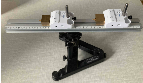
Abb.5: Versuchsaufbau zur gleichzeitigen Messung von Zentripetal- und Zentrifugalkraft mit Sensoren von PASCO. Die Schwerpunkte der Testmassen befinden sich im jeweils gleichen Abstand zur Rotationsachse.
