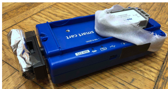
Abb.2: Vorbereitetes Fahrzeug (PASCO Smart Cart) mit einer gerollten Aluminium-Folie als Knautschzone und einer Mullbinde als Rückhaltesystem für den lose auf dem Fahrzeug liegenden Beschleunigungssensor als Modell eines Fahrzeug-Insassen.
