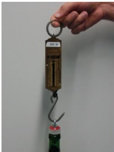
Abb. 2: Bestimmung der Haftreibungskraft
