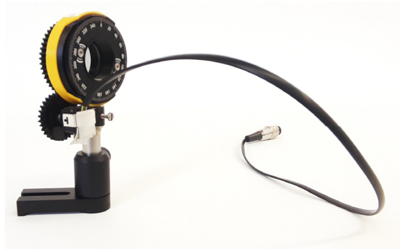
Abb. 4: Modifizierte Halterung zur Erfassung des Drehwinkels optischer Komponenten.
