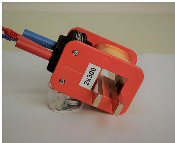
Abb.3: Das stromdurchflossene Weicheiseninstrument
