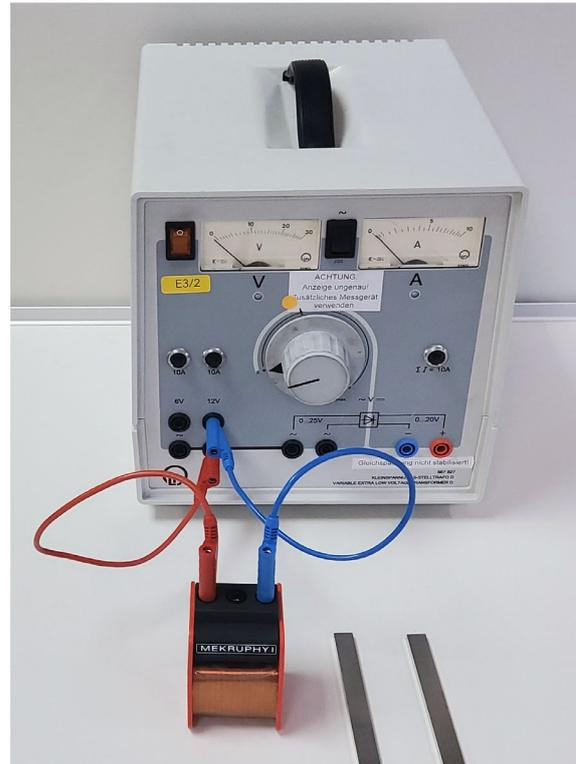
Abb.2: Materialien der Station 6 - Weicheiseninstrument
