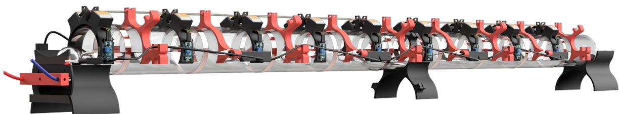
**Abb. 3:** 3D-gedrucktes, mikrocontroller-gesteuertes Modell eines Wechselspannungs-Linearbeschleunigers
