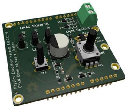
**Abb. 4:** LINAC-Shield zum Aufstecken auf einen Arduino Uno
