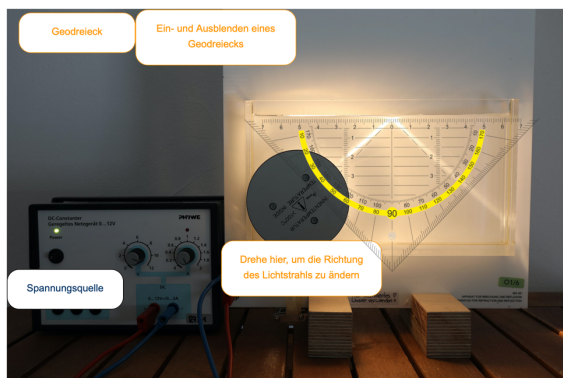
Abb. 9: Interaktives Bildschirmexperiment zur qualitativen Untersuchung der Totalreflexion
