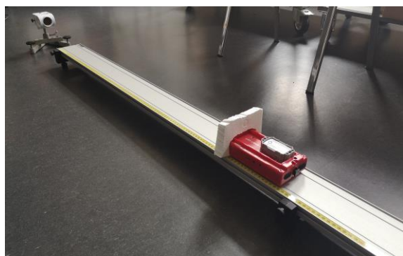
Abb. 2: Foto des Aufbaus zur Bewegung eines Wagens auf einer Aluminiumbahn mit den Sensoren von Pasco.
