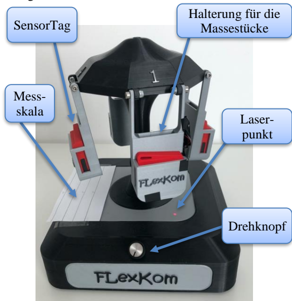
Abb.1: Foto des "FLeXKom-Karussells". Der Drehknopf steuert über ein Potentiometer die Drehgeschwindigkeit. Die roten Sensormodule (SensorTags) dienen der Bestimmung der Frequenz über die App phyphox und lassen sich aus den Halterungen herausnehmen. Der Strahl eines in einer Gondel verbauten Lasers wird zum Ablesen des Auslenkwinkels genutzt.
