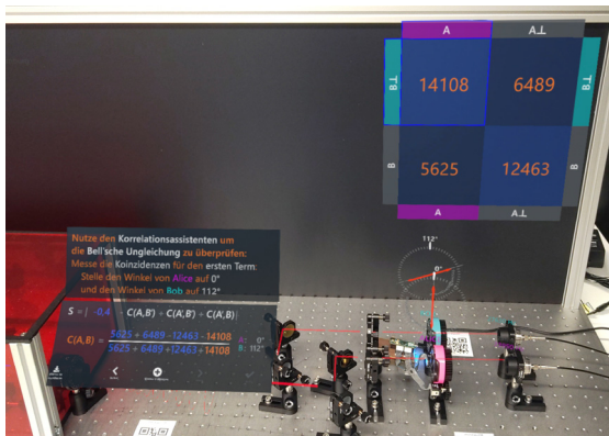
Abb. 6: Assistentensystem zur Einstellung der richtigen Winkel bei Messung der Bell'schen Ungleichung (unten links) und grafische Darstellung der Korrelationsfunktion (oben rechts).
