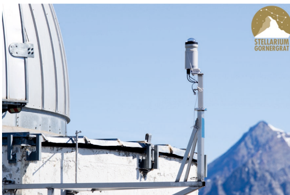
Abb. 5: Die AllSky-Kamera. Credit: Stellarium Gornergrat. Foto: T. Riesen, https://stellarium-gornergrat.ch/instrumente/ .
