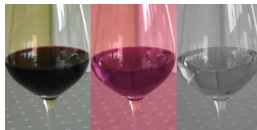
Abb. 21: Rotwein, aufgenommen mit sichtbarem Licht (links), IR und sichtbarem Licht (Mitte), nur IR (rechts)
