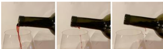
Abb. 11: Gewünschte Strömung ins Glas hinein (links) und unerwünschte Strömung entlang des Flaschenhalses (Mitte und rechts)
