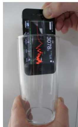
Abb. 22: Versuchsaufbau zur Bestimmung der Schallgeschwindigkeit mit einem Pfälzer Schoppenglas
