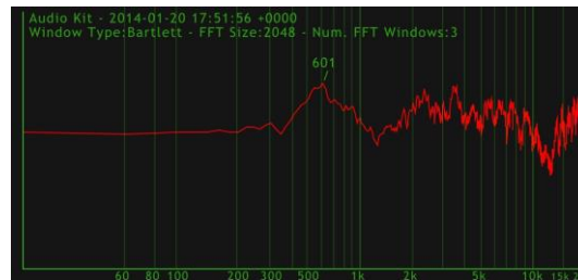
Abb. 26: Die Resonanzfrequenz des verwendeten Rotweinglases beträgt 601 Hz, aufgenommen mit Audio Kit
