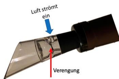
Abb. 10: Handelsüblicher Weinausgießer mit Venturi-Düse
