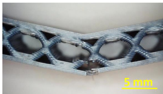
Abb. 4: 3D-gedruckte Probe nach dem 3-Punkt-Biegetest. Aus Koske, D.; Ehrmann, A. (2021) Infill designs for 3D-printed shape-memory objects. In: Technologies 9, 29. DOI: https://doi.org/10.3390/technologies9020029 , im Original veröffentlicht unter einer CC-BY-Lizenz https://creativecommons.org/licenses/by/4.0/ .
