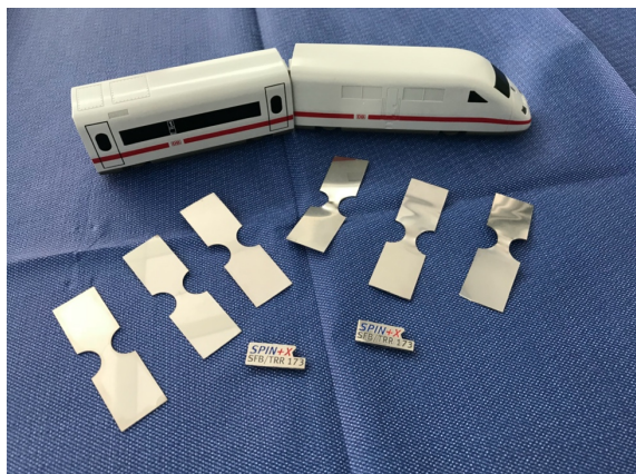
Abb. 1: Demonstrator zur Phasenumwandlung in Stahl. Links: drei ungebogene, flache Stahlplättchen, rechts: drei gebogene, magnetische. Vorne liegen zwei Magnete mit Spin+X-Logo und die Spielzeugeisenbahn hinten dient der Veranschaulichung des Anwendungsgebietes.
