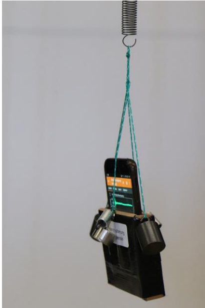
Abb. 6: Foto des Smartphones in einer Halterung für die Aufnahme mit der Smartphone-App PhyPhox.
