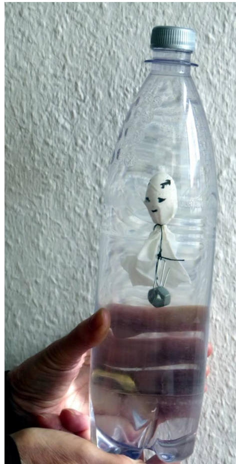
Abb. 13: Kartesischer Taucher aus dem Finger eines Latexhandschuhs
