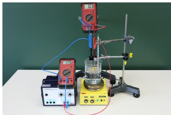
Abb. 13: Möglicher Versuchsaufbau zum Schülerexperiment zur Ermittlung des Einflusses der Temperatur auf die Intensität der Elektronenströmung
