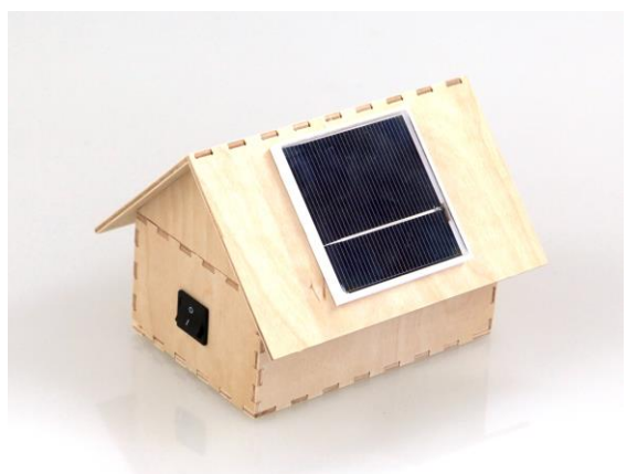
Abb. 2: Modellhaus mit Solarzelle. Die Messdaten für Strom, Spannung und Leistung bei unterschiedlicher Beleuchtungsstärke der Solarzelle werden per Bluetooth in Echtzeit auf das Smartphone übertragen und mit der App phyphox dargestellt.
