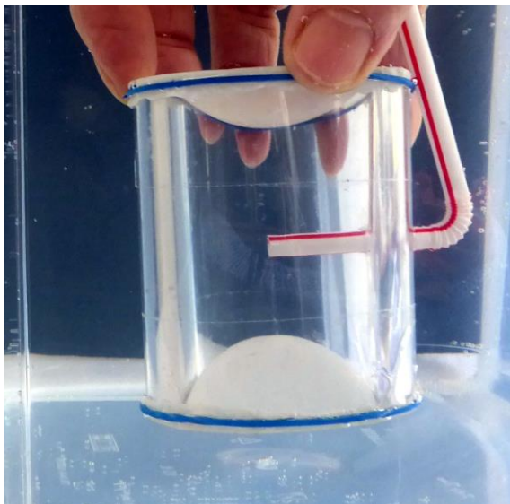
Abb. 6: Druckdose vertikal im Wasser, beide Membranen sind unterschiedlich stark nach innen gedrückt.
