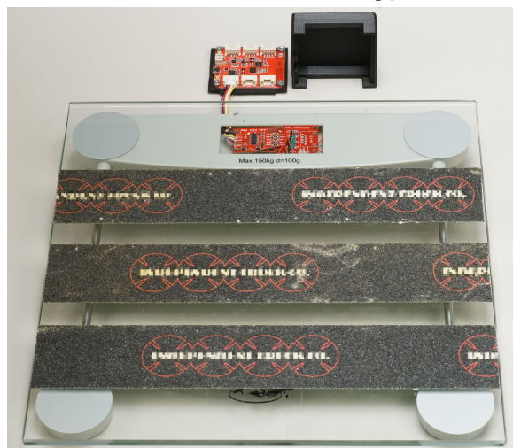
Abb. 1: Rutschfest umgebaute Personenwaage an WiFi-fähigem ‚WIO-Link‘-Controller
