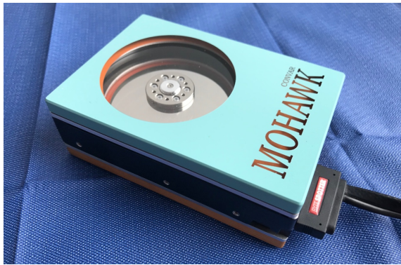
Abb. 3: HDD-Festplatte mit Sichtfenster, durch das der Lesekopf beobachtet werden kann.
