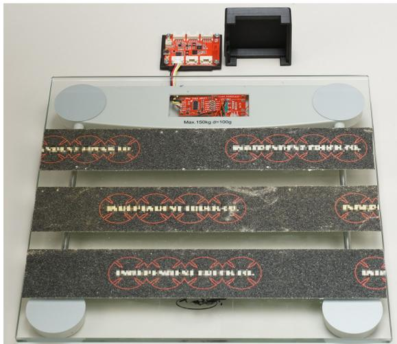
Abb. 1: Rutschfest umgebaute Personenwaage an WiFi-fähigem ‚WIO-Link‘-Controller
