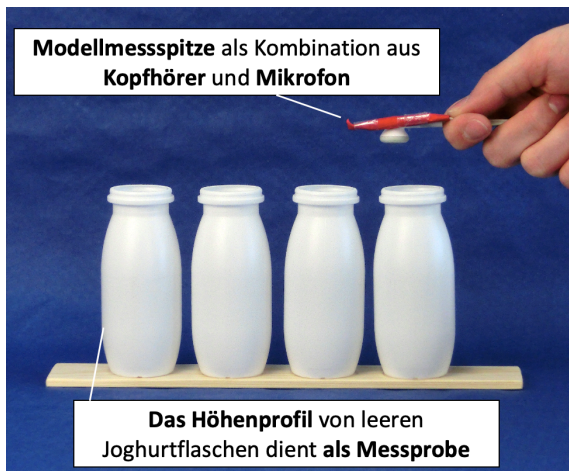
Abb. 11: Modellexperiment zur Funktionsweise des Rastertunnelmikroskops.
