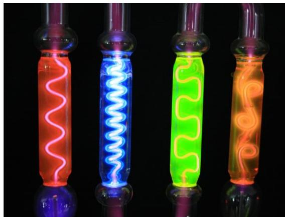
**Abb. 2:** Gasentladungsröhren mit fluoreszierenden Flüssigkeiten.
