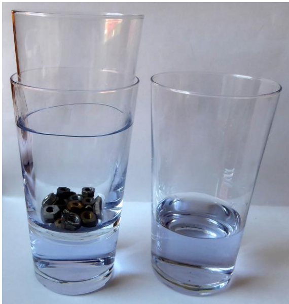
Abb. 2: Das innere Glas schwimmt und verdrängt einen Bruchteil seines eingetauchten Volumens
