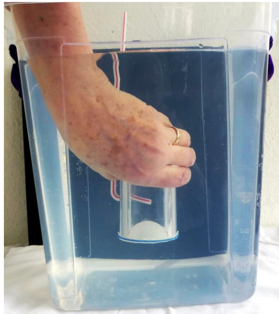
Abb. 3: Druckdose im Wasser, Trinkhalmende in Luft; die Membran wird stark nach innen gedrückt.
