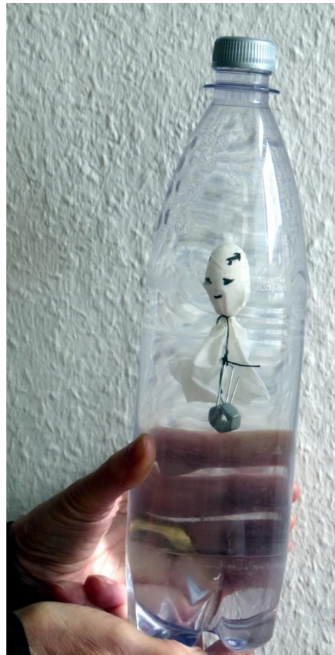
Abb. 13: Kartesischer Taucher aus dem Finger eines Latexhandschuhs
